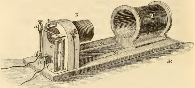
FIG. 71. — Appareil volta-faradique de Du Bois-Reymond.
